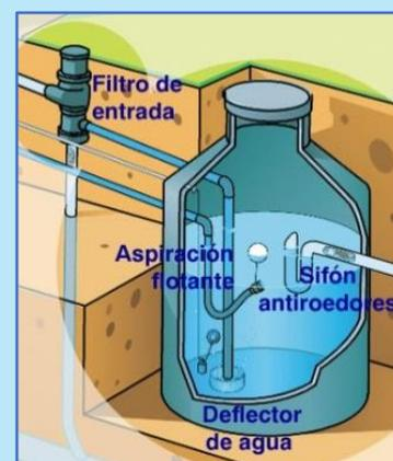
Figura 3. Sistema de cisterna para captação de água da chuva.
