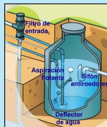
Figura 2. Sistema de cisterna de para captación de lluvia.
